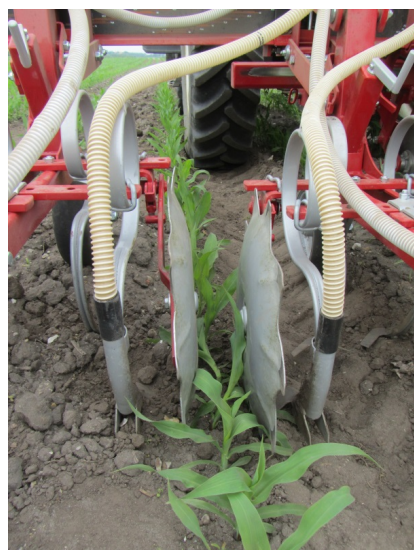
Billede 1. Billedet viser gødningsudstyr monteret på en radrenser. Gødningen lægges i jorden 10-15 cm fra rækken bag den yderste tand på radrenseren. Foto: Henning Sjørsløv Lyngvig, VFL.
